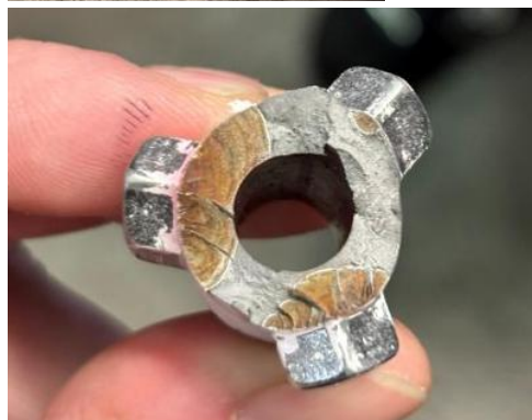
Mode de rupture VG avec fissures débouchantes
