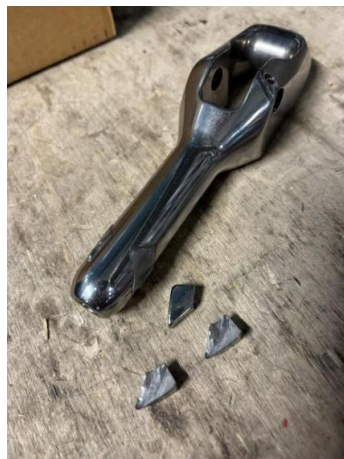
Rupture en cisaillement (Pièce neuve)
