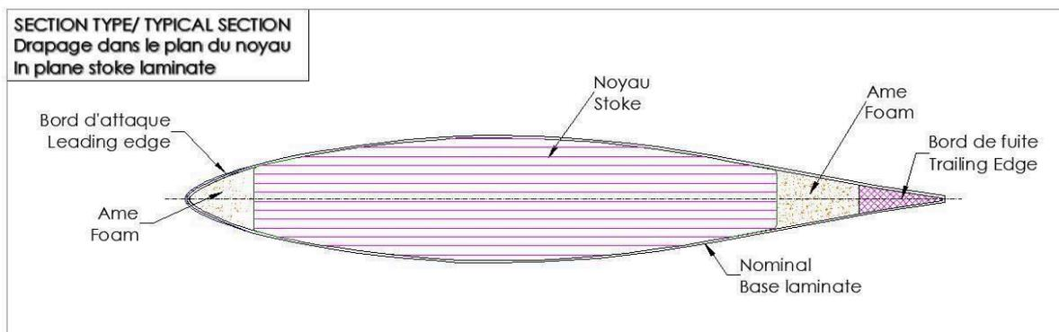
Le noyau du foil est construit (drapage) suivant le principe dit "Dans le Plan" ; les fibres HM sont alors autorisées à la seule condition qu'elles soient disposées en respectant strictement le schéma ci-dessus {parallèle à la corde du foil}.
